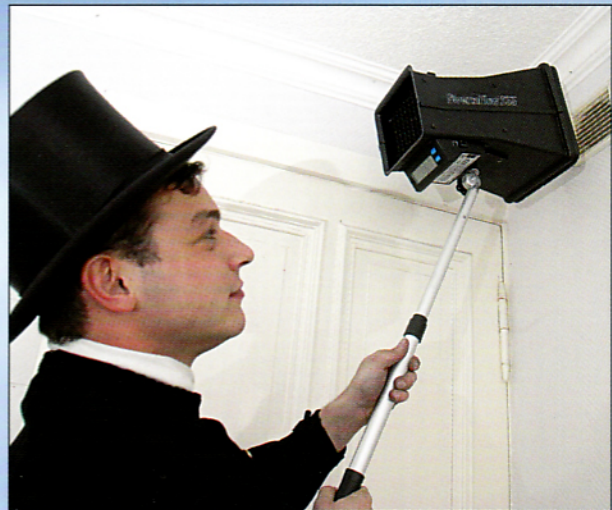
Luftvolumenstrommessung in einer Wohnung
